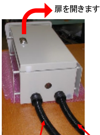
[写真1] カメラケーブル用チューブ 電源入力ケーブル用チューブ
